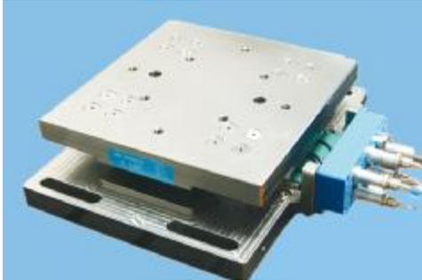
多分力测力台能提供一个基于测力平台上表面正交直角坐标系上的三个方向的准静态和动态测力（ $F_x$ 、 $F_y$  或  $F_z$ ）以及三个方向的力矩（ $M_x$ 、 $M_y$  和  $M_z$ ）。
